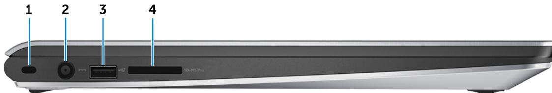
**1** **Слот для защитного кабеля**
